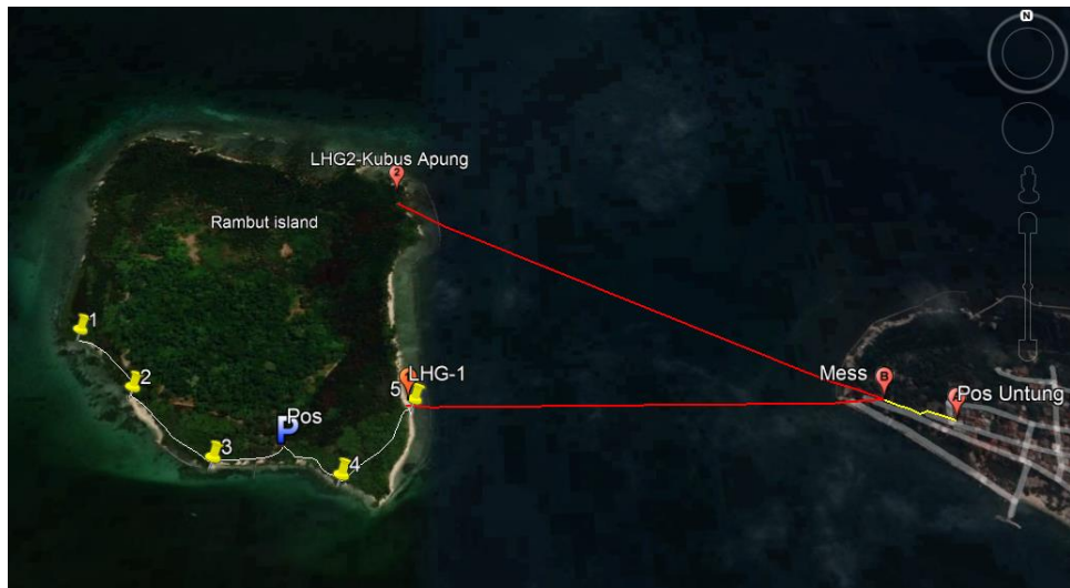
a. Topologi Intrekoneksi CCTV Renewable Energy di SMPR dan Pulau Untung Jawa
