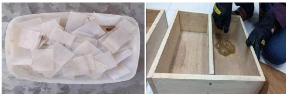
**Gambar.** Limbah *jerrycan* dicacah (kiri) dan proses pencetakan dan pengepresan (kanan)
