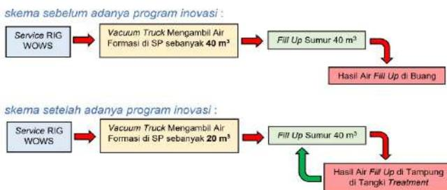
**Gambar.** Skematis/visual inovasi Program Sirkulasi Air Formasi dalam Proses Well Service
