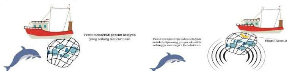
**Gambar.** Sebelum adanya program (pemasangan pinger akustik) (kiri) dan setelah adanya program (pemasangan pinger akustik) (kanan)
