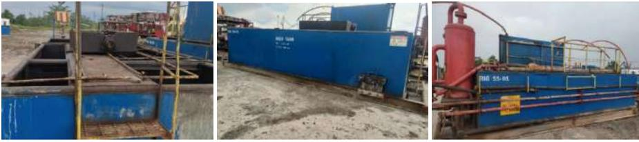
**Gambar.** Treatment tank untuk menampung dan mengolah air formasi
