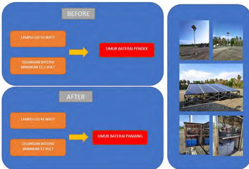
Gambar. Gambaran Skematis atau Visual Program Inovasi Perubahan Cutoff Voltage Solar Cell
