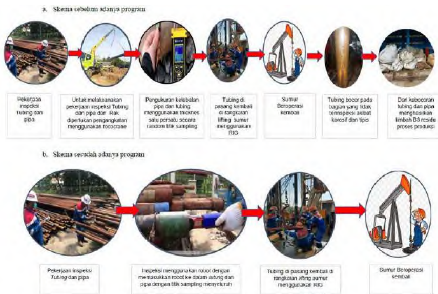
Gambar. Skema Program Pengurangan Frekuensi Kebocoran Pipa dan Tubing dengan Perubahan Sistem Inspeksi Menggunakan Robot Thicktube
