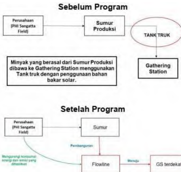
Gambar. Dokumentasi Program Piping System (Penggantian Truck Pengangkut Dengan Sistem Pipa Pengangkutan)
