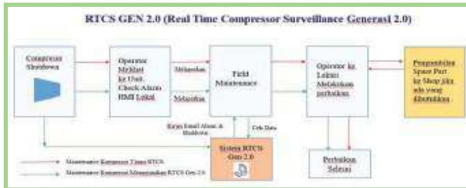
Gambar 27. Alur Perenapan Modifikasi RTCS Gen 2.0)
